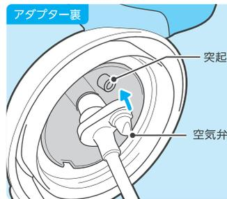
**C** ストロー弁側をつまみ、根元にある凸部が表面に出るまで引っ張ります。ストローが隙間なく取り付けられているか確認してください。
