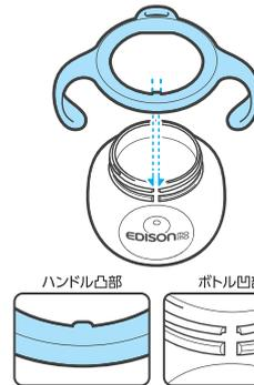
**B** ボトルとハンドルの凹凸がずれないように手で押さえながらアダプターが回らなくなるまで締めてください。ロックとブランドロゴが正面に揃っていることを確認してください。
