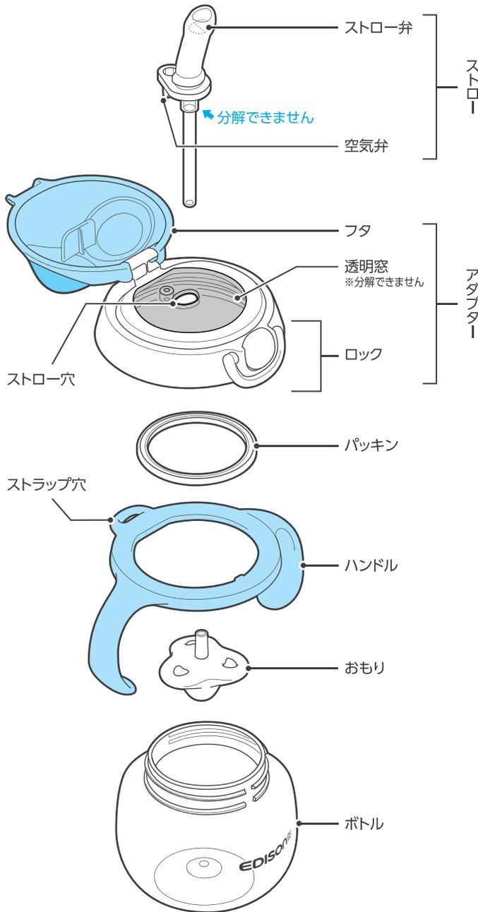
**B** 透明窓裏面の突起と空気弁の凹凸が合うようにはめ込みます。
