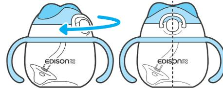
※ボトルとハンドルの凹凸がずれると、完全に締まらず、漏れの原因となります。ハンドルを押さえながら締めてください。※フタを閉じてからアダプターを締めてください。飲み物が噴出したり、部品に無理な力が加わったりするおそれがあります。
