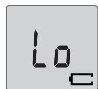
電池交換マークが、左図の画面のように表示されたら新しい電池と交換してください。
